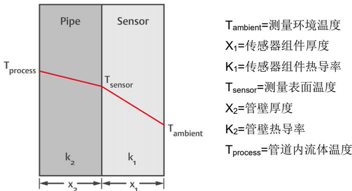
如上图示，使用卡箍管道安装型产品 TTD6N 检测管道内流体温度  $T_{\text{process}}$  时，其实际检测的温度  $T_{\text{sensor}}$  会与管道内流体温度  $T_{\text{process}}$  有差异。导致差异的影响因素有：管道材质导热系数  $k_2$ /厚度  $X_2$ ，传感器检测导热系数  $k_1$ /厚度  $X_1$ ，外部环境温度  $T_{\text{ambient}}$  及环境风速、安装靠贴结合度等。为了减小  $T_{\text{sensor}}$  与  $T_{\text{process}}$  差异，提高检测精度，需注意安装中靠贴部分清洁、紧密、导热良好，另外管道和靠贴部分还建议都加包保温材料。如果有条件通过其它方式实际测量温度  $T_{\text{process}}$ ，进而可以计算其与通过 TTD6N 产品实际测量结果  $T_{\text{process}}$  的偏差，就可以通过计算校正测量结果  $T_{\text{process}}$ ，得到更准确的测量值。
